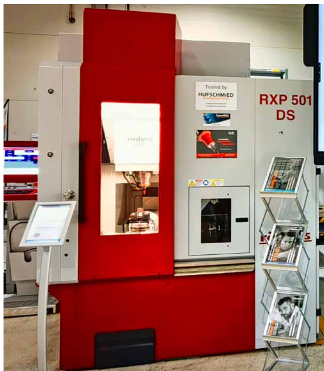
该样品是在Hufschmied技术中心使用五轴Rödgers RXP 501 DS铣削的。该系统配备了MHT介质分配器（照片：Klaus Vollrath）。
