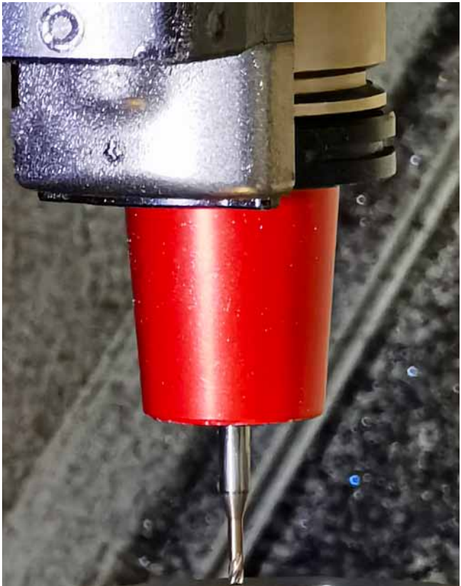
MHT介质分配器的空心套筒在不接触或不随工具夹头旋转的情况下包围了工具夹头。空气和润滑剂通过位于主轴下方的对接接口供应 (Photo: Klaus Vollrath)
