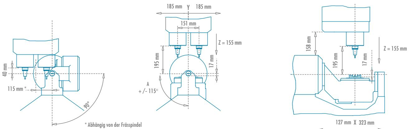
Zweispindelmaschine ohne Werkzeugwechsler, Verfahrbereich eingeschränkt
