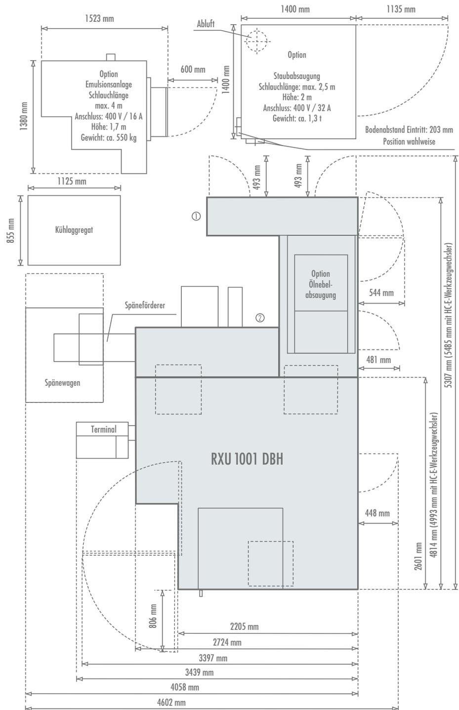
① = Maschinenanschlüsse (Strom, Netzwerk)
