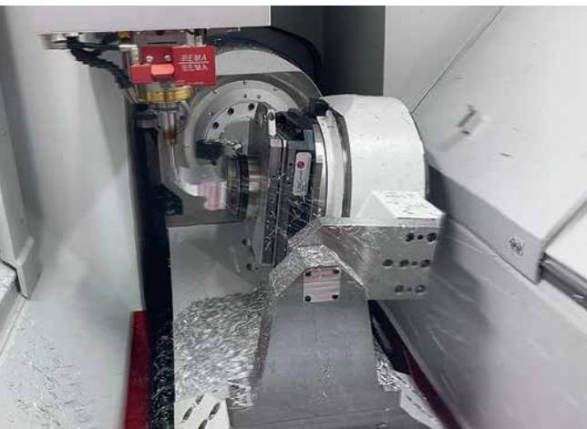
Zum Fräsen von Freiformflächen braucht es die richtige Strategie und 5-Achs-Maschinen: Und mit der Beschleunigungsoptimierung Racecut verspricht Rödgers rund 20% kürzere Bearbeitungszeiten – und das ohne Verluste an Genauigkeit und Oberflächengüte.
