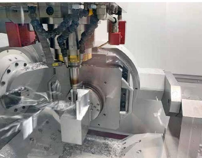
20 min brauchte der VHM-Fräser zum Schruppen und Schlichten, bevor ein Diamantfräser von Horn in 10 min die hochglänzenden Oberflächen erzeugte.
