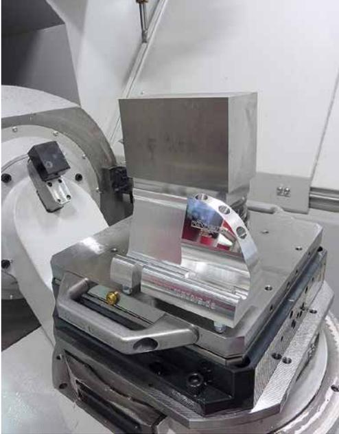
Aluminiumblock wird zum Hochglanz-Handyhalter: Rödgers fräste auf der Formnext in Frankfurt auf einer RXP 601 DSH in nur 30 min einen wunderschönen Prototypen.
