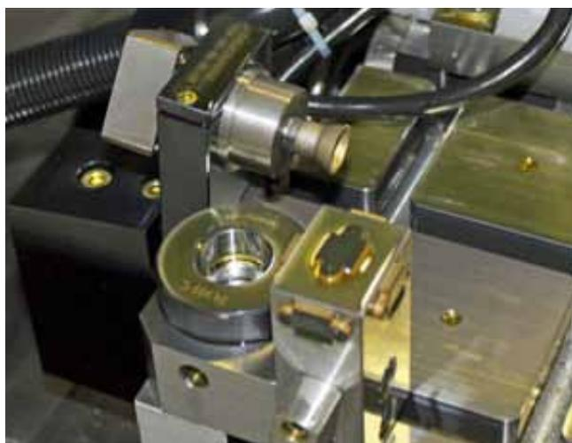
Zur Spezialausstattung für das Schleifen gehören eine Abrichtrolle (Mitte oben), darunter der Referenzring für die spezielle doppelte Kalibrierung des Tasters sowie rechts daneben ein fünffach-Sensor für die Anschlifferkennung per Körperschall (Foto: Klaus Vollrath)
