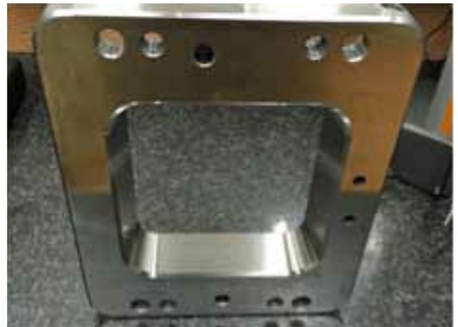
Schräghubgeschliffene Abstreifer-Platte mit einer Härte von 58 HRC (Foto: T.Schmid)
