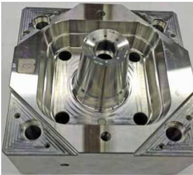
Schräghubgeschliffener Formeinsatz mit einer Härte von 56 HRC. Toleranz der konischen Passflächen  $2.5\ \mu\text{m}/\text{Seite}$  (Foto: T.Schmid)
