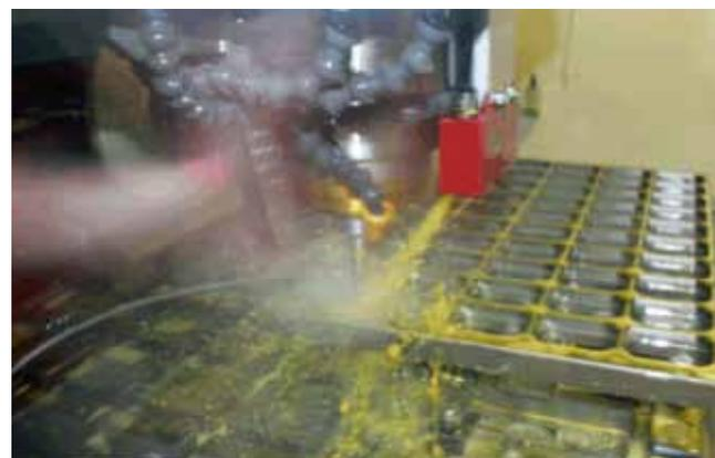
Voller Einsatz der RXP 801 beim Schnellhubschleifen an einer Matrize mit 50 Nestern. Schnittspalt 2µm/ Seite. (Foto: Klaus Vollrath)
