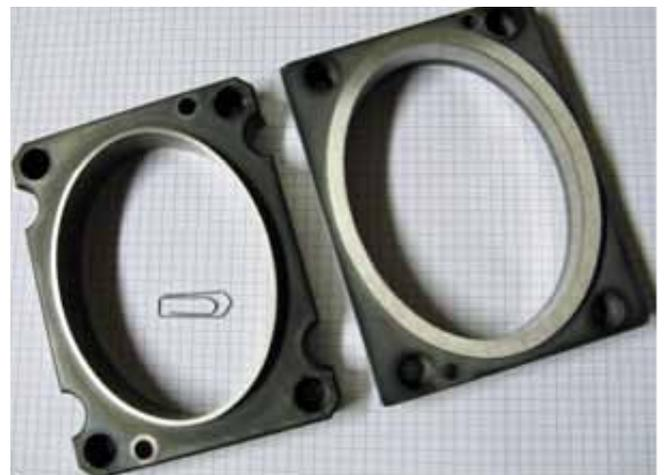
Stempel und Matrize für das Stanzen dünner Aluminiumfolien. Toleranz des Schneidspaltes  $3 \mu\text{m}$  (Foto: Klaus Vollrath)
