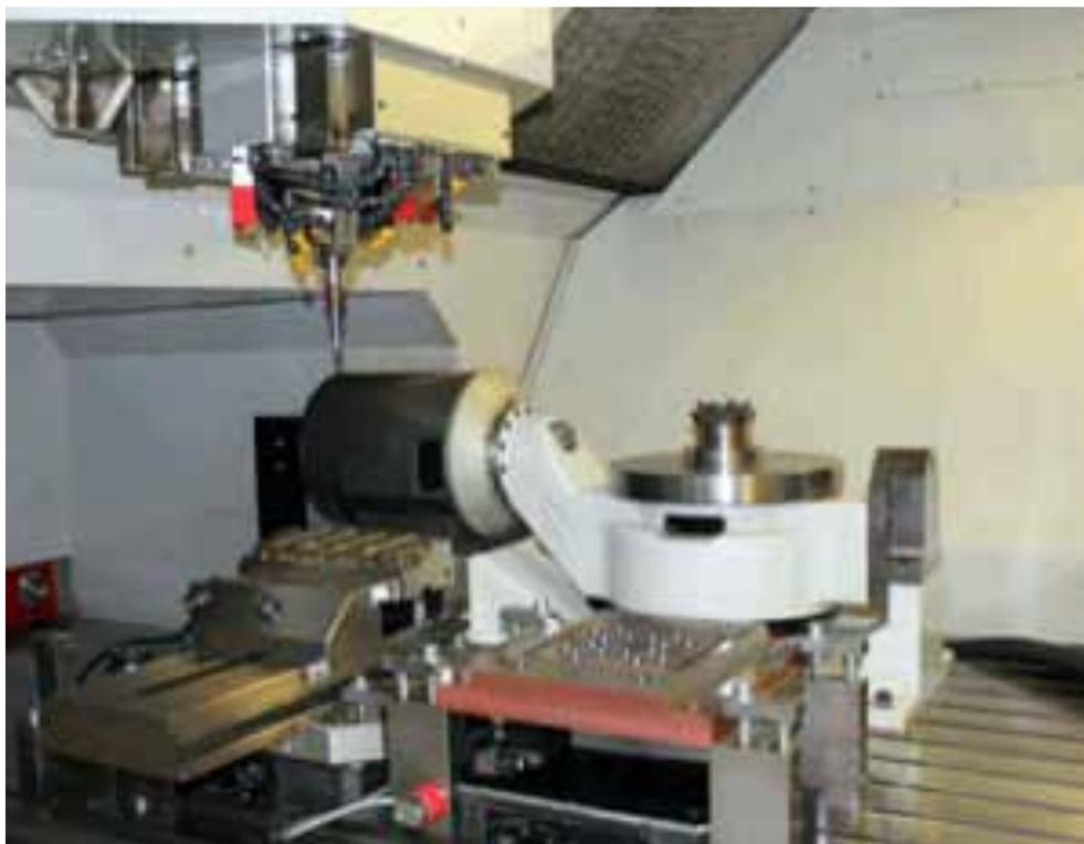
Blick in den Arbeitsraum der RXU 1200. Im Hintergrund der aufgesetzte Dreh-Schwenktisch. Besonderheit der Anlage ist die besonders steife, an allen vier Ecken geführte Quadroguide-Z-Achse (Foto: Klaus Vollrath)
