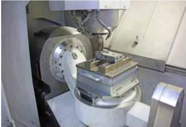
Der Arbeitsraum der RXP 601 DSH. In der Mitte der robuste, beidseitig gelagerte Dreh-Schwenktisch, das Gegenlager auf der rechten Seite weist eine Tragzahl von 7000 kg auf (Foto: Klaus Vollrath)
