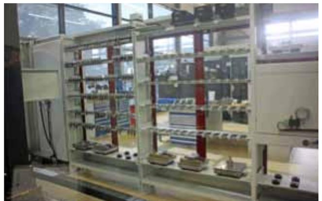
Der Innenraum der RCM-Automatisierung mit Fräswerkzeugen (links), Werkstückpaletten (mittig und unten) und Greiferbahnhof (ganz oben) (Foto: Klaus Vollrath)
