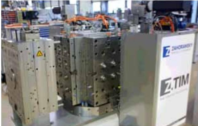
Das Z.TIM-Stack Spritzgießwerkzeug besteht aus zwei Werkzeugseiten mit mittig liegendem Drehwürfel. Damit lassen sich zwei unterschiedliche Teile auf einem Werkzeug herstellen (Foto: Klaus Vollrath)
