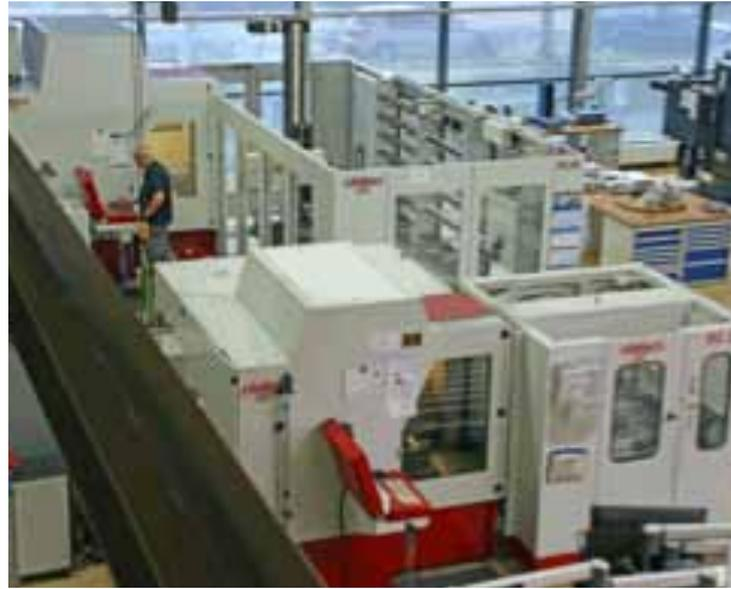
Die beiden automatisierten Röders-Fertigungszellen. Vorne eine RXP 500 DS mit RC 2 Karussellmagazin, hinten eine RXP 601 DSH mit erweiterbarem RCM Linearmagazin für Werkstücke und Werkzeuge (Foto: Klaus Vollrath)
